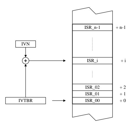
Wenn die Startadressen der Interrupt-Service-Routinen breiter sind als die Speicherbreite (z.B. 64-Bit Adressen bei einem 32-Bit Prozessor), dann belegt jeder Vektor mehrere Speicherworte. Die Addition des Index zur Basis muss dann natürlich skaliert erfolgen, wobei die Skalierung das Verhältnis von Vektorbreite zu Speicherwortbreite darstellt.
