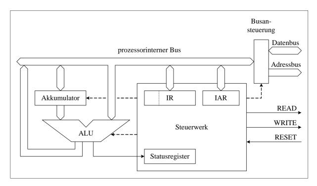
Der Akkumulator ist das zentrale Rechen- bzw. Arbeitsregister der 1-Adress-CPU in der Datenverarbeitungseinheit (ALU = *Arithmetic Logic Unit*). In der Befehlsverarbeitungseinheit (kurz Steuerwerk) sind folgende Ressourcen vorhanden:
