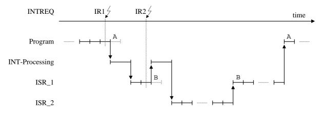
Die Anforderung von IR1 wird vom Interrupt-Controller zur CPU durchgeschaltet, die übermittelte Vektor-Nummer führt zur ISR\_1. Während des *Interrupt-Processings* wird der INTREQ automatisch deaktiviert (PSW.IF='0'). Die IR1-*State-Machine* befindet sich im Zustand under\_service. Innerhalb der ISR\_1 wird der enable-int Befehl (PSW.IF='1') ausgeführt. Damit führt eine aktive INTREQ-Leitung zu einer weiteren Interruptverarbeitung.
