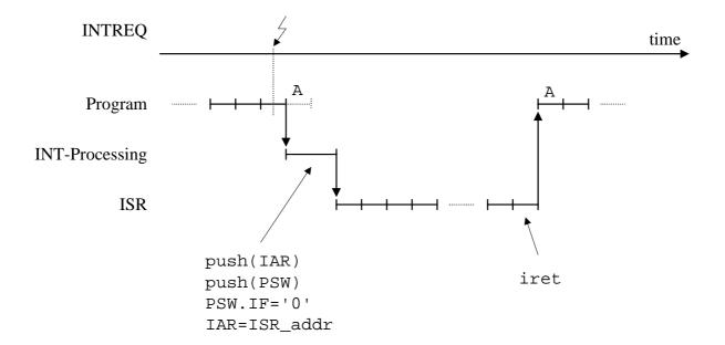
Die Abbildung zeigt sehr schön, dass die ISR parallel zum unterbrochenen Programm ausgeführt wird. Und genau dort liegt ein großes Problempotential, wenn die ISR nicht "transparent" ist.
