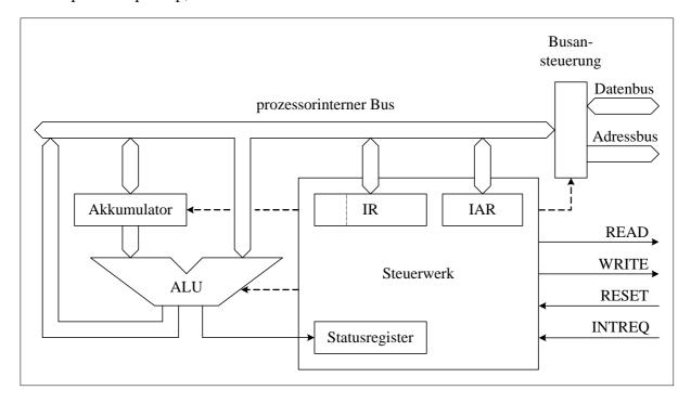
Wenn der HW-Interrupt eintrifft (INTREQ wird aktiv), dann verzweigt die Programmverarbeitung zu einer Funktion, welche an einer vordefinierten Stelle im Hauptspeicher liegt. Diese spezielle Funktion wird als *Interrupt Service Routine* (ISR) bezeichnet. Der HW-Interrupt realisiert einen von extern ausgelösten, somit asynchronen Funktionsaufruf. Das erweiterte Operationsprinzip lautet:
