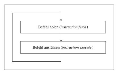
Die CPU muss zuerst einen Befehl holen (aus dem Speicher lesen) und kann ihn anschließend ausführen. Danach wird der nächste Befehl geholt. Programme werden somit streng sequentiell abgearbeitet. Ohne zusätzliche Einrichtungen gibt es keine Möglichkeit asynchron auf externe Ereignisse zu reagieren und somit gewissermaßen eine Parallelverarbeitung zu implementieren.
