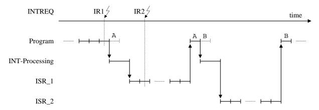
Die Anforderung von IR1 wird vom *Interrupt-Controller* zur CPU durchgeschaltet, die übermittelte Vektor-Nummer führt zur ISR\_1. Während des *Interrupt-Processings* wird der INTREQ automatisch deaktiviert (PSW.IF='0'). Die IR1-*State-Machine* befindet sich im Zustand under\_service.
