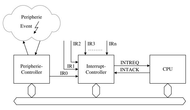
Der Peripherie-*Controller* erzeugt als Folge eines Peripherie-*Events* einen *Interrupt-Request* (IR), der an den *Interrupt-Controller* weitergeleitet wird. Der *Interrupt-Controller* erzeugt einen INTREQ und leitet ihn an die CPU weiter. Die CPU quittiert den INTREQ mit einem
