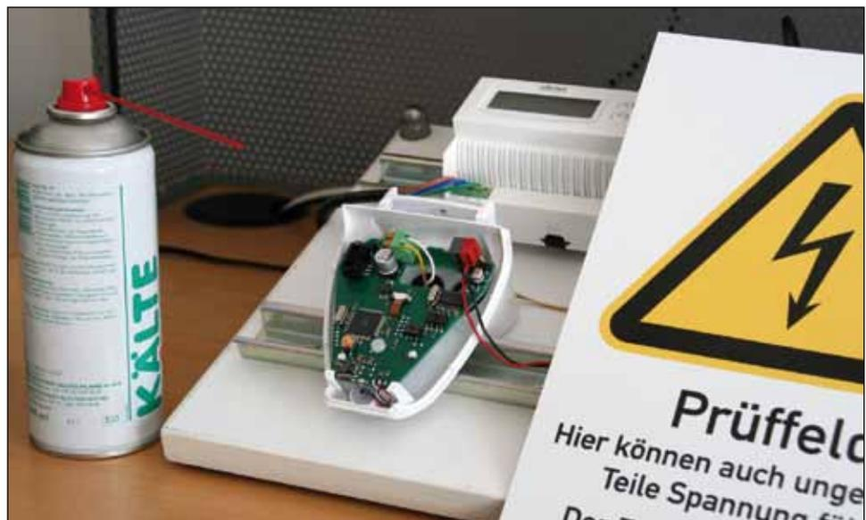
Prüfaufbau für einen Wettersensor. Mit dem Kältespray kann auf einfache Weise z. B. der Windmesswert beeinflusst werden.
